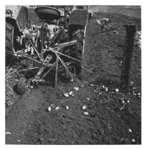
Abb. 1: Schleudergraber an Traktor angebaut, ausgerüstet mit Stützrad und Fangrechen.
