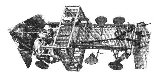
Abb. 6: Sammelroder nach dem Schüttelsiebprinzip, ausgerüstet mit einer Förderkette und Verlesetisch.
