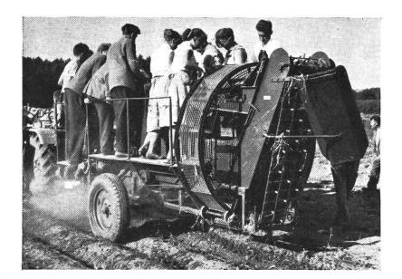
Abb. 8: Vollerntemaschine nach dem Siebkettenprinzip. Auf dem Bild sichtbar Hubrad mit Kunststoffschnüren und die Krautausscheiderkette.
