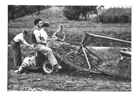
Abb. 5: Schüttelsiebgraber mit Auslesetisch, der aus einem in schiefer Ebene rotierenden Rad besteht.
