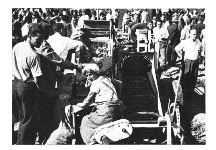
Abb. 10: Vollerntemaschine mit Abschiebtrommel und Sortiervorrichtung.
