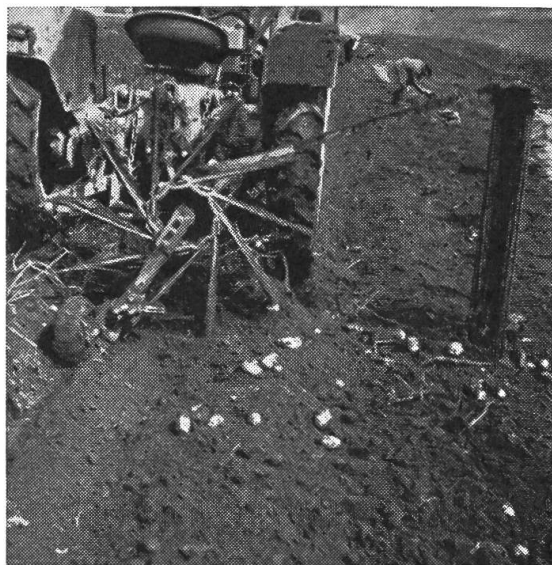
Abb. 1: Schleuderradgraber an Traktor angebaut, ausgerüstet mit Stützrad und Fangrechen.
