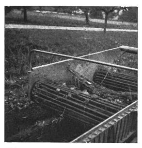
Abb. 2: Siebkettengraber mit Fallstufe und eingehängtem Kettenbund.
