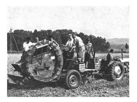
von kurzen Kraut- und Stengelteilen dient, auf das Verleseband gebracht. Auf dem Verlesetisch werden von mitfahrendem Personal die Knollen aus dem Unrat oder umgekehrt herausgelesen und dann einem Bunker oder der Absackvorrichtung zugeführt.
