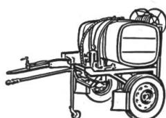
Bimoto - Z E N I T H BC IV A, aufgebaut auf Zweiradwagen mit 600 Liter-Holzfass — Rühr-Injektor — grosser Saugfilter — Druckleitungsfilter — Schnellschlussahn — 11-reihiger Spritzbarren — Spritzausrüstung mit 15 m Hochdruckschlauch und Spritzrohr 45 cm — Kardanwelle
