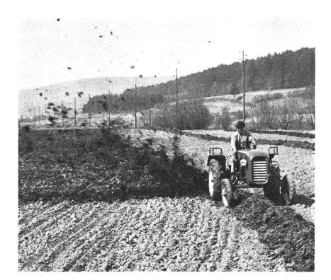
Abb. 2: Mistausschleudern vom Schwaden (Häckselmist) mit Schleuderradgraber
