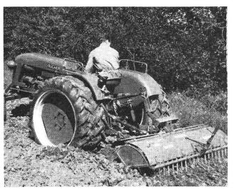
Abb. 8a: Fallinienpflügen mit mittelschwerem Traktor unter Anwendung des Anbaupfluges und der Antischlupfmethode bei 33% Steigung
