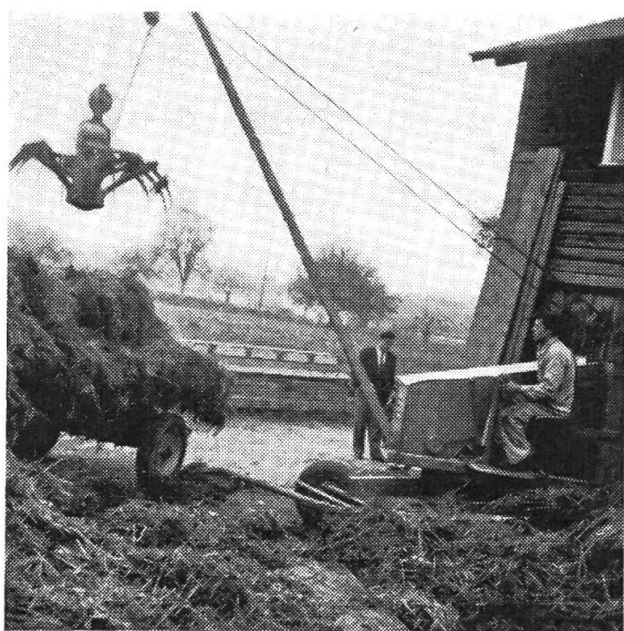
Abb. 1a und 1b: Fahrbarer Ladekran, ausgerüstet mit Selbstgreifer (Einmannsystem)
