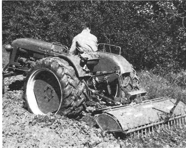
Abb. 8a: Falllinienpflügen mit mittelschwerem Traktor unter Anwendung des Anbaupfluges und der Antischlupfmethode bei 33% Steigung
