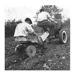
Abb. 7: Das Seilzuggerät «Spinne» ermöglicht das Kartoffelpflanzen mit halbautomatischen Pflanzgeräten (ebenfalls 2reihiges Hacken und Häufeln) am Steilhang
