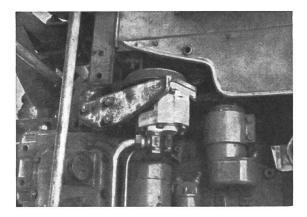
Fig. 3: Angebaute Bosch-Pumpe
