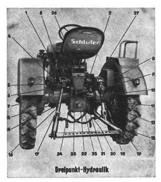
Abb. 6: Anordnung eines Dreipunkt-Anbaues an einem Schlüter-Traktor:
