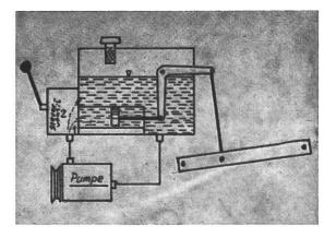
Fig. 4: Schematische Darstellung einer Hydraulikanlage in Blockform
