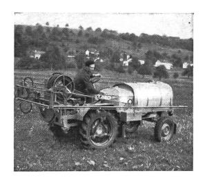
mit Hochdruckpumpe BIMOTO-TITAN BH-II Druckentlastungsventil, 60 Atm. Druck, 75 I/min. Förderleistung. 4-Zylinder VW-Motor, luftgekühlt, 25 PS, 6 Vorwärtsgänge u. 1 Rückwärtsgang. — Verblüffend einfache Spurverstellungs-Vorrichtung.
