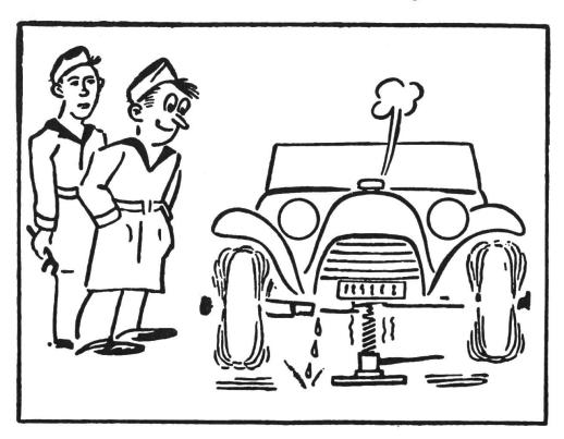
Die Darstellung im Bild nebenan ist übertrieben, jawohl. Dabei ist die Uebertreibung jedoch nicht einmal besonders krass. Wenn ein Wagen mit unausgewuchteten Rädern zur Gleichgewichtskontrolle aufgebockt wird, flattern und schlagen dieselben. Praktisch kommt das ununterbrochene Fahren mit nicht ausgewuchteten Rädern einem Selbstmord des Wagens gleich.
