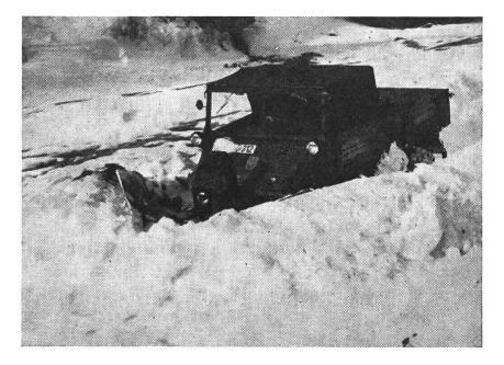
Abb. 11: Unimog mit angebautem Keilschneepflug in Tätigkeit
