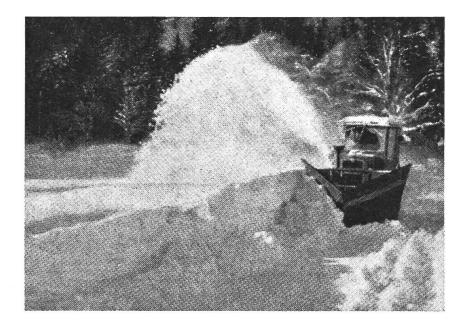
Traktor angebaut und mittels Gelenkwelle von der vorderen bzw. hinteren Zapfwelle des Traktors angetrieben.
