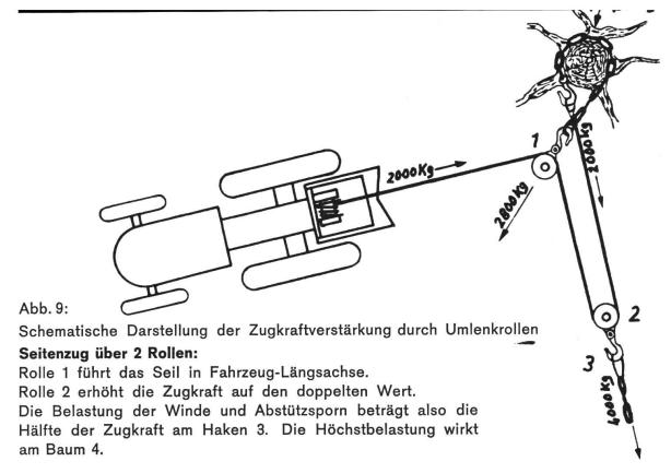
im günstigen Leistungsbereich arbeiten und gleichmässiger durchziehen. Der Rollendurchmesser der Umlenkrolle soll möglichst über 200 mm liegen.
