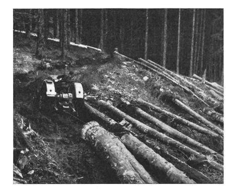
aus durch Betätigung des Schalthebels der Winde. Das Abrollen des Seiles geschieht durch Schwenken des Schalthebels nach vorn in Fahrtrichtung, das Aufwickeln durch Drücken des Hebels nach hinten. Bei der Inbetriebnahme der Seilwinde ist in folgender Reihenfolge vorzugehen:
