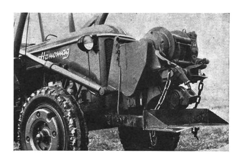
Abb. 1: Front-Seilwinde mit 6 to-Seilzugkraft
