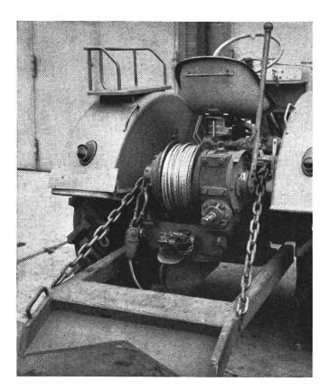
Abb. 2: 3,5 to-Anbauseilwinde am 25 PS-Traktor mit Zapfwellendurchtrieb und drehbarer Anhängerkupplung
