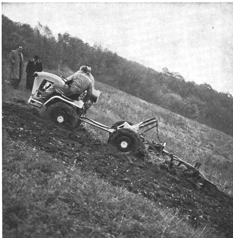
PULLAX beim Pflügen am Steilhang mit Seilzug und 4-Rad-Antrieb
