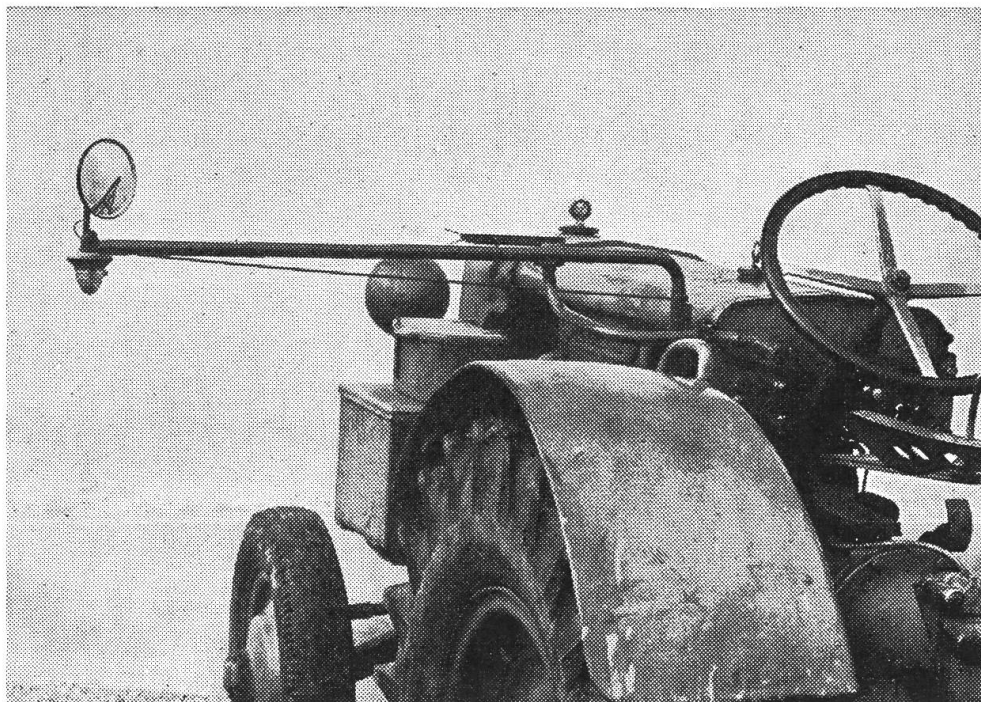
Ansicht von hinten des ausgeschwenkten Blink- und Spiegelgerätes «Argus». Man beachte links aussen: oben: den Spiegel unten: den Blinker
