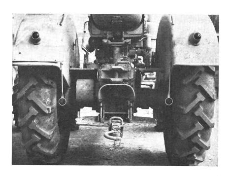
Traktor mit höhenverstellbarer Anhängerkupplung, Zapfwellenschutz und Rücklichtern und Rückstrahlern
