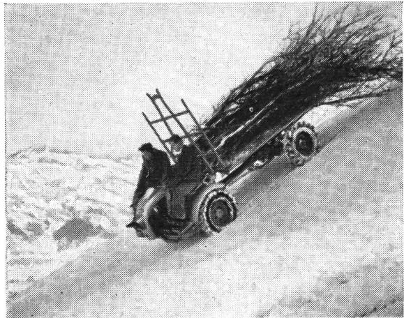
**Mit kurzgestelltem Radstand und Dreipunkt-Hydraulik — der ideale Vielzwecktraktor mit 4-Rad-Antrieb.**
