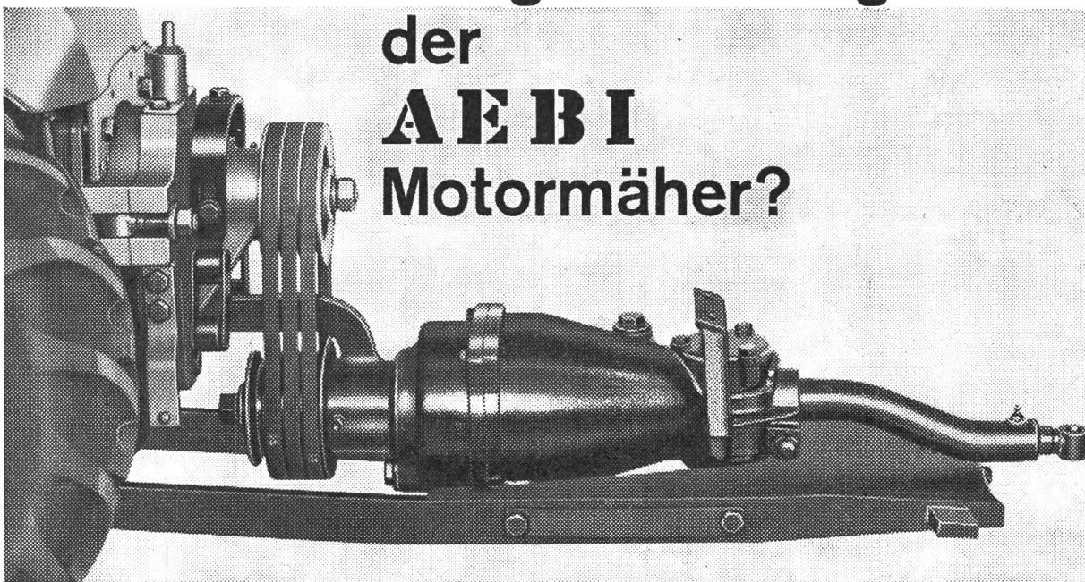
Sie verdanken ihn ihrer einzigartigen Konstruktion mit frei schwingend aufgehängtem Mähapparat und Keilriemenantrieb. Die am Messerbalken auftretenden unvermeidlichen Erschütterungen können in diesem Mähapparat frei ausschwingen und werden deshalb nicht auf die Maschine übertragen, so schnell auch das Messer laufen mag. Die Keilriemen schützen außerdem wirksam gegen Bruch an Klingen und Fingern.
