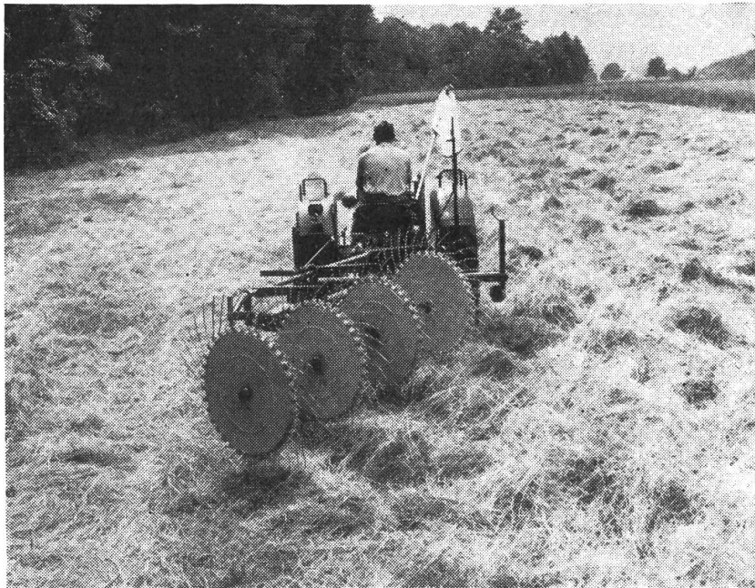
Der Rotorrechen RC 4, eine neuartige und vielseitige Erntemaschine, die man für verschiedene Arbeiten vorne und zum Breitwenden hinten am Traktor einsetzt.
