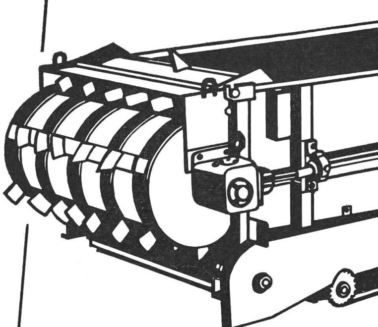
Die Streutrommel ist das Herz eines jeden Mistzetters. Hier entscheidet es sich, ob die Maschine fein oder weniger fein ausstreut, ob sie Langstrohmist ebenso gleichmässig zettet wie unverrotteten Mist. Die AGRAR-Mistzettmaschine hat nur eine Trommel, diese dreht aber mit etwa 800 t/min. Dadurch erzielen Sie eine Streuarbeit, so dicht und gleichmässig wie ein Teppich. Die Streudichte können Sie leicht vom Traktorsitz aus regulieren.
