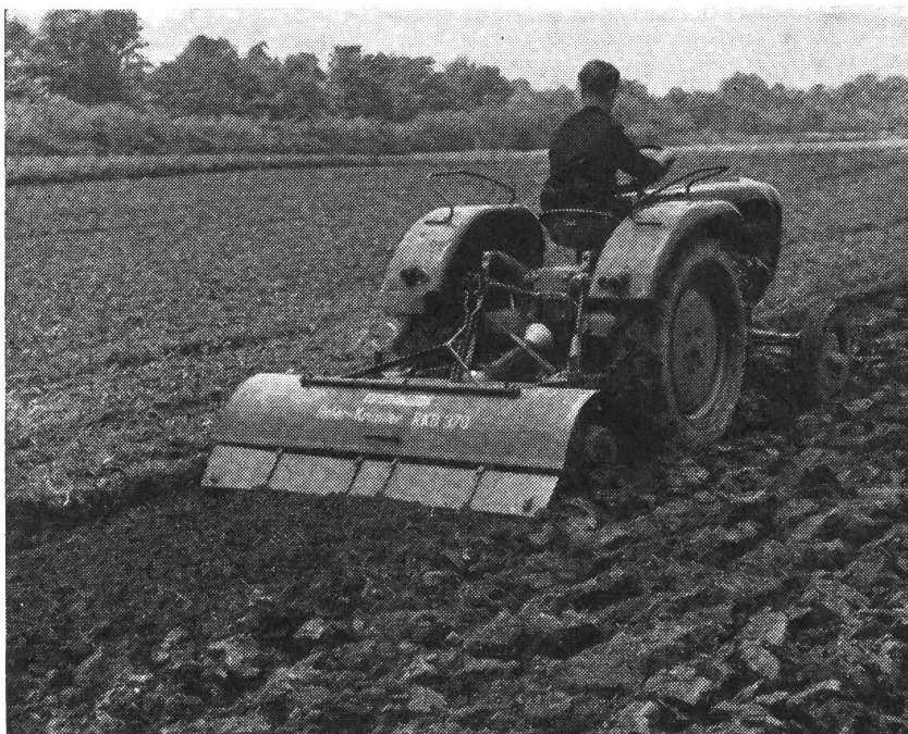
Abb. 7: Eberhardt-Anbau- Rotorkrümler angebaut am Bautz-Traktor 300 Werkfoto: Fa. Gebr. Eberhardt, Ulm
