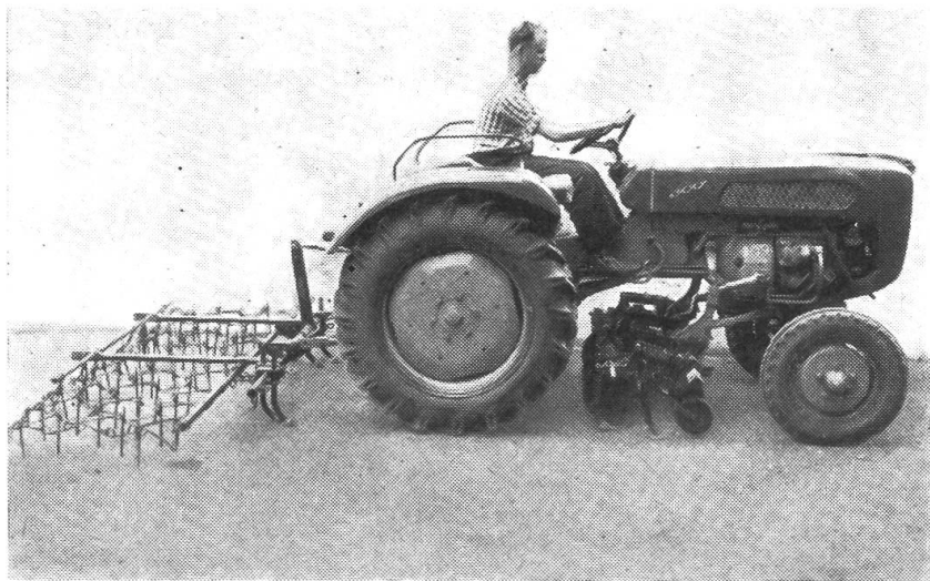
Abb. 12 Traktor ausgerüstet mit der Arbeitskette: Netzegge-Spurlocke- rer-Zwischenachs- rübenpflegegerät für die Rübenflege
