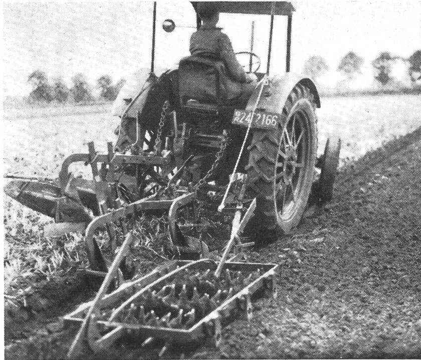
Abb. 4 Winkeldrehpflug mit Krümelegge im Arbeitseinsatz Werkfoto: Fa. Pflug- fabrik Ewald Hilde- brand & Co.
