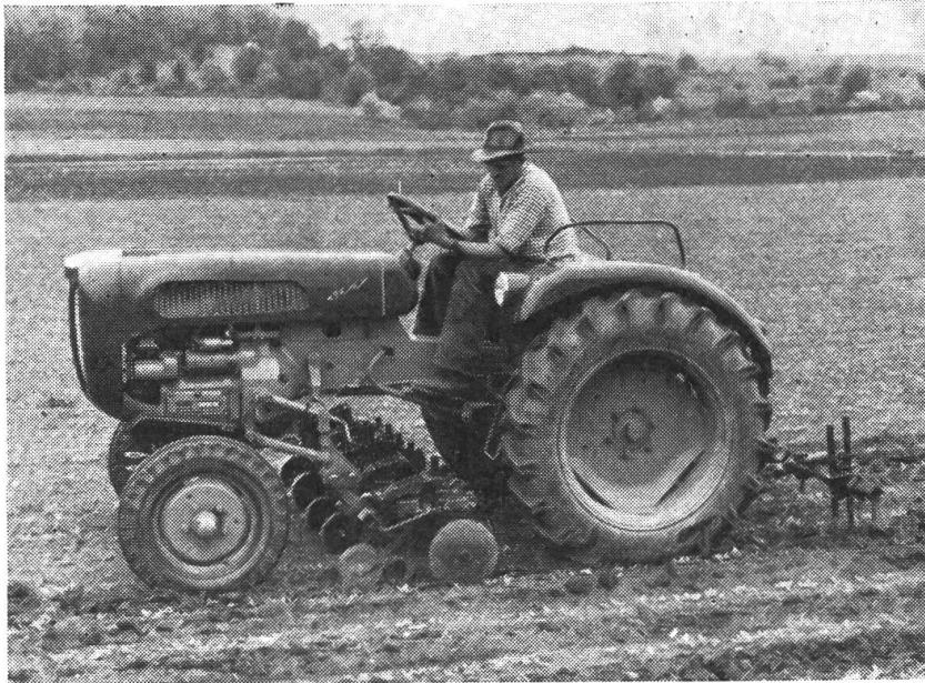
Abb. 11 Traktor mit Zwischen- achsrübenpflegegerät und Spurlockerer im Arbeitseinsatz
