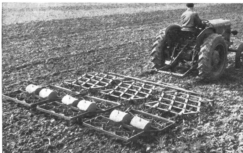
Abb. 3 Traktor mit angehäng- ten Eggen und Kombi- Krümler Werkfoto: Niedersachsen-Werk, Rabber
