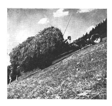
Abb. 2: Einachstraktor mit Triebachsanhänger am Steilhang.
