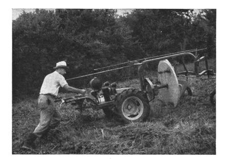
Abb. 3: Motormäher mit Front-Vielzweckrechen am Steilhang bei 45 % Steigung.
