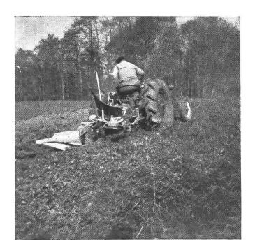
Abb. 6: Fallinienpflügen mit Normaltraktor und Anbaupflug (Achsdruckverstärkung) bei 33 % Steigung.
