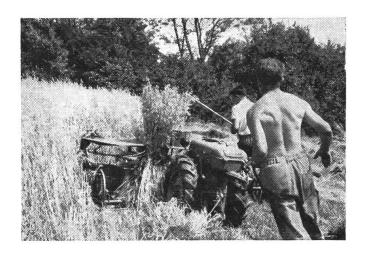
Abb. 4: Einachstraktor mit Frontbinder bei 40 % Steigung.
