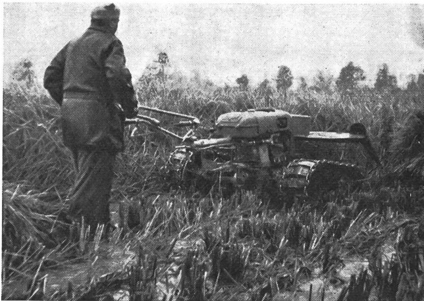
Zum Reismähen wurden die Triebräder des Einachstraktors und die Tragräder des Frontbinders mit Raupenketten versehen.
