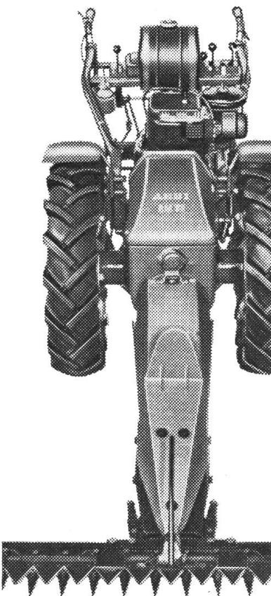
Alle diese AEBI-Motormäher haben den frei schwingenden Mähapparat mit Keilriemenantrieb (ruhige Sterzen, wirksam-ster Schutz gegen Bruch an Klingen und Fingern) und den patentierten AEBI-Messerkopf.
