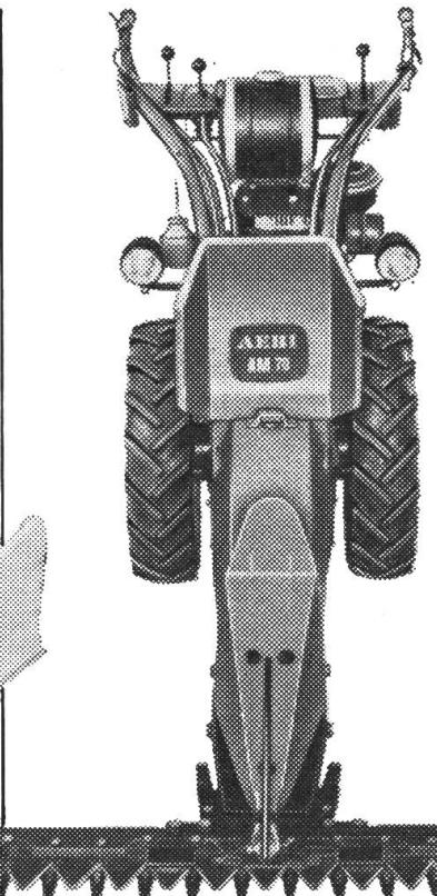
der Mehrzweck-Motormäher mit Motor 7—8 PS, 4 Vor-wärtsgängen, 2 Mähgängen, Differential mit Sperre, Licht-anlage, Radspur 450 und 700 mm. In der Ebene zum Ein-grasen und zum Heuen mit dem AEBI-Heuer; in den Ber-gen zum Mähen sowie zum Ziehen mit dem Triebachs-anhänger.
