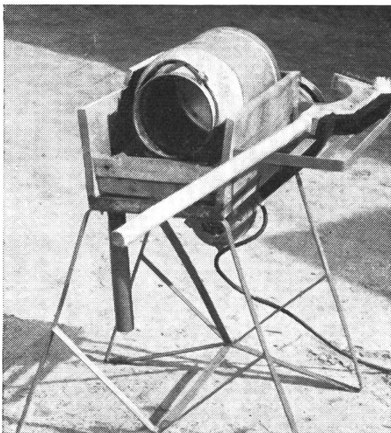
Abb.7: Bei der Kannenwaschmaschine «Elso» dreht sich die eingespannte Kanne im Spültrog. Sie kann innen und aussen mit der langstieligen Bürste intensiv bearbeitet werden.
