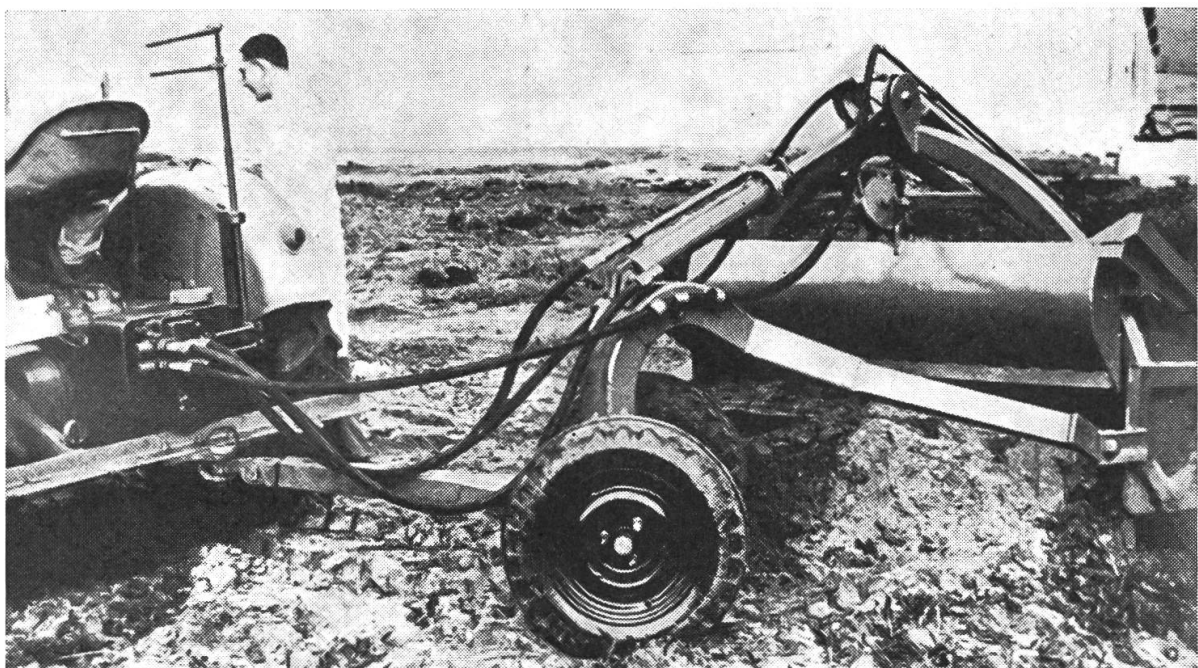
Abb. 4: Scraper mit doppeltwirkenden Arbeitszylindern (2 Stück) am Traktor angehängt
