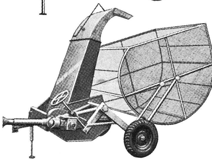
Für das tägliche Eingrasen ist der ERNTEROTOR-Feldhäcksler, mit kippbarem Graskorb ausgerüstet, die ideale Maschine.
