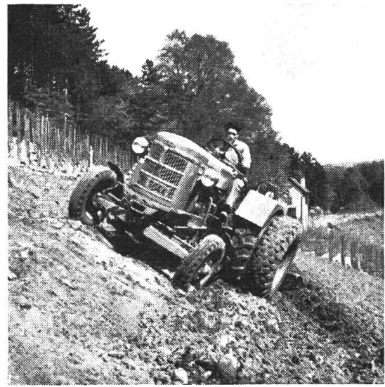
Abb. 4: Traktor mit Doppelbereifung beim Fräsen am Hang. Man beachte, dass die Hinterräder nicht seitlich abrutschen, wie dies bei Einzelradausrüstung der Fall wäre.
