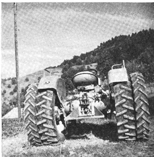
Abb. 9: Traktor mit Doppelbereifung 8-32 und 10-28. Diese Anordnung der Reifen ist empfehlenswert für die Jahreszeiten, da nicht gehackt werden muss.
