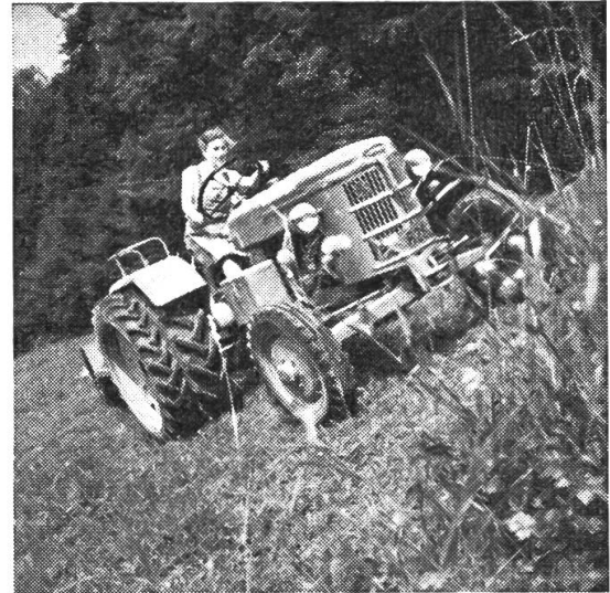
Abb. 14: Am Hang kommt die Doppelbereifung besonders auch ungeübten Fahrern zugute.
