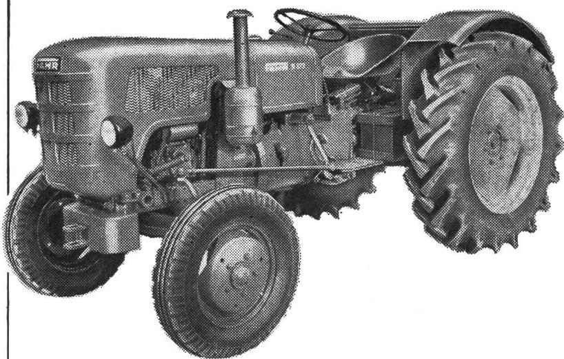
Ein Traktor modernster Konstruktion und mit sehr interessanten neuen Vorteilen, mit 34-PS-Vierzylinder-Dieselmotor, mit 8 Vorwärts- und 4 Rückwärtsgängen, mit Servomatic, mit Motor- und Wegzapfwelle und kupplungsunabhängiger Hydraulik.
