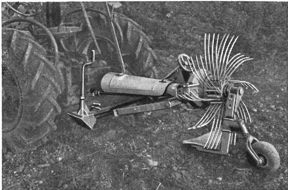
seitlich und in der Höhe vom Sitz aus verstellbar. Antrieb im Oelbad auf Kugellager laufend. Für alle Traktoren mit zentraler Zapfwelle, mit und ohne Hydraulik. Kombinierbar als Rübengraber. **Vorrats-Siebroder «Schmotzer», neuester Ausführung**
