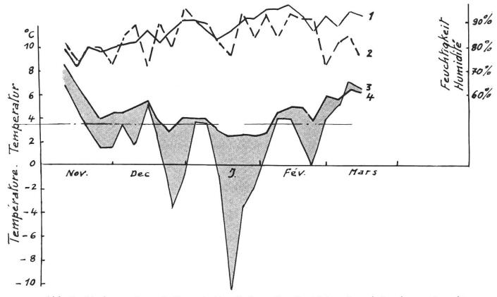
Abb. 3: Moderner Lagerkeller mit Ventilation. Da die Linien 3 und 4 nahe aneinander sind, deutet das auf eine gute Ueberwachung und Ausnützung der kostenlosen Aussenkälte. Bei unrationeller Ventilation sind die Linien 3 und 4 auseinander.
