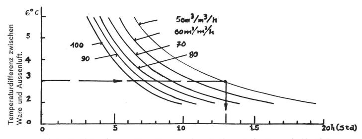
Abb. 1: **Ventilationskurven.** Diese Kurven geben die theoretische Dauer der Ventilation in Funktion der Differenz zwischen der Innen- und Aussenluft und der Luftmenge in m³ Luft für 10 Tonnen Kartoffeln. Wegen den thermischen Gesetzen der Wärmeübertragung und Abfuhr, ist die wirkliche Zeit etwas länger.
