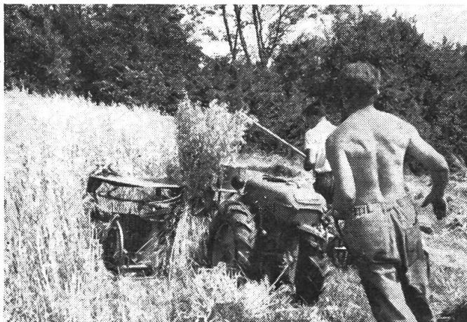
Abb. 2a und 2b: Einachstraktor mit stützradgelenktem Frontbinder bei 45 % Steigung.
