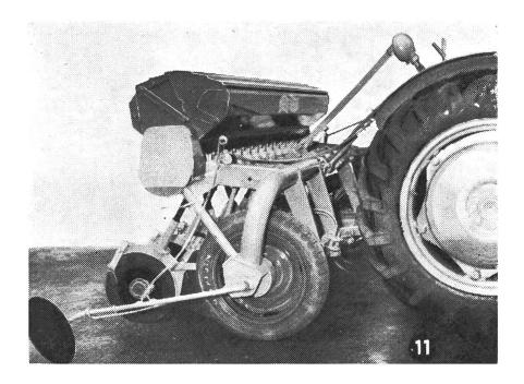
hen werden durch Ablenker in der mittleren Reihe zusammengefasst. Auf der nun folgenden Rückfahrt (im Gegensinne) wird die Schraubenschnecke herabgelassen. Sie drückt die drei nun gerodeten Reihen auf die drei vorher gerodeten, so dass nun 6 Reihen zusammen abgelegt sind.
