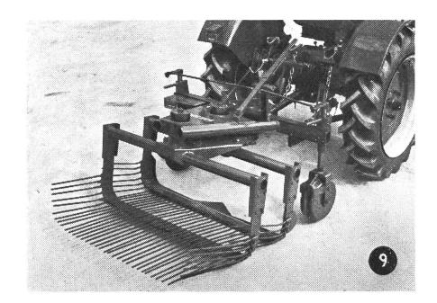
Die hydraulische Hebung bewirkt ein Auseinandergehen der Rollen gefolgt von einer Selbstreinigung.
