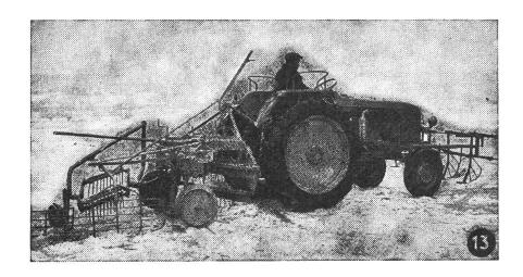
eine Gruppe von drei Spezialrodescharen ersetzt. So werden 3 Reihen Rüben gerodet, gereinigt und gemeinsam abgelegt. Das Gerät wiegt 300 kg und kann an alle Traktoren mit Zapfwelle aufgebaut werden.
