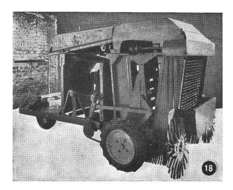
verlängerung arbeitet sie mit mittlerer Druckkraft und zwei Knüpfern. Der Umbau des Gerätes von niedriger auf mittlere Druckkraft vollzieht sich in knapp einerhalben Stunde.
