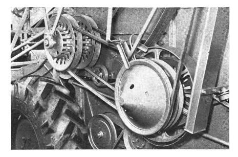
chem Achsabstand erfolgen. Danach werden die Riemen auf Vorspannung gebracht.
