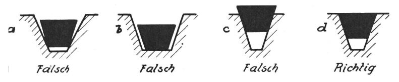
Abb. 3 Falsche und richtige Lage des Keilriemens in der Keilriemenscheibe
