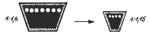
Abb. 4 Gegenüberstellung von Norm- und Schmalkeilriemen bei gleicher Riemengeschwindigkeit und Riemenleistung
