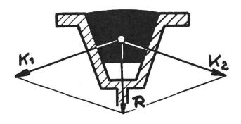
Abb. 1 Kräfteverhältnis beim Keilriemen kung). Dies bedeutet, dass die Durchzugskraft des Keilriemens dreimal so gross ist wie die des Flachriemens.
