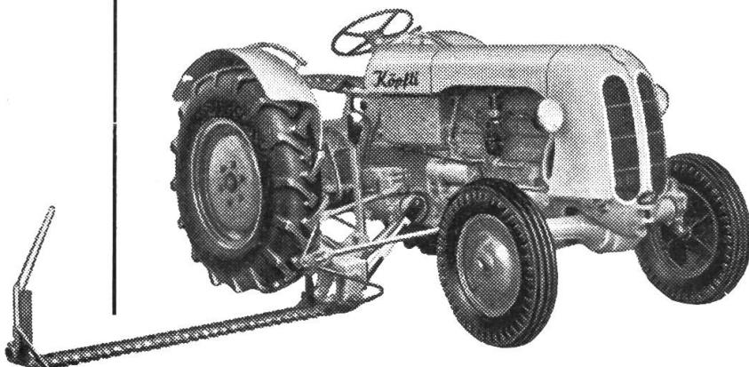
Lieferbar mit Doppelkupplung und unabhängiger Zapfwelle. Getriebeunabhängige, hydraulische Hebevorrichtung hinten und seitlich. Patentierte Ganzranklenkung. Mähapparat mit bewährter Sicherheitskupplung.
