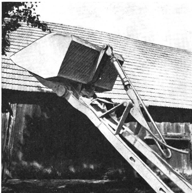
Abb. 2. Muldenschaufel in Transportstellung. Unter dem Muldenboden das keilförmige Unterstützungselement. Der Haltehebel ist in das Querstück des Fixierungsbockes eingehackt. Der Haken ist nicht sehr tief (was auf dem Titelbild zu erkennen ist), so dass das Aushaken von Hand keinen grossen Kraftaufwand erfordert.
