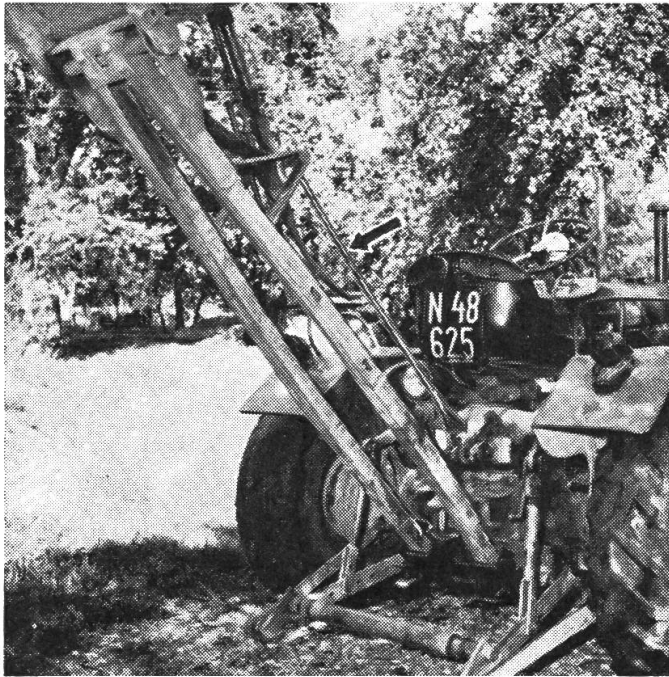
Abb. 4. Der Hecklader ist zum Transport steil gestellt. Im linken Bilde deutet ein Pfeil auf die Haltestange hin, welche den Hecklader hochhält. Die Hydraulik ist gesenkt.
