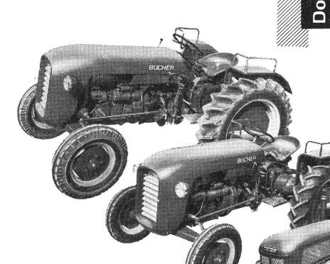
mit luft- oder wassergekühlten Motoren. Darunter die Modelle mit Contraschlupf, unabhängiger Hydraulik, fahrabhängiger und kupplungs-unabhängiger Zapfwelle, 2 Messergeschwindigkeiten sowie Doppelkupplung und Doppelsteuergerät.
