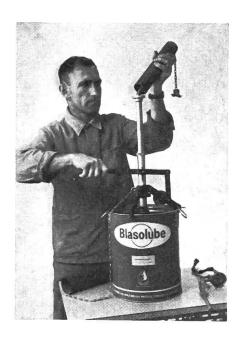
Mit diesem praktischen Fett-Abfüllapparat geht das Abfüllen der Fettpressen viel schneller. Noch wichtiger ist aber, dass keine Verunreinigungen mehr ins Fett gelangen ... und darum keine schädlichen Bestandteile in die Kugellager. Die Schmierung ist viel sicherer, weil sich in der Fettpresse keine Luftblasen mehr bilden. Man ist demnach sicher, dass tatsächlich Fett in die Lager kommt. Es geht kein Fett mehr verloren. Die Handhabung ist ganz leicht.
