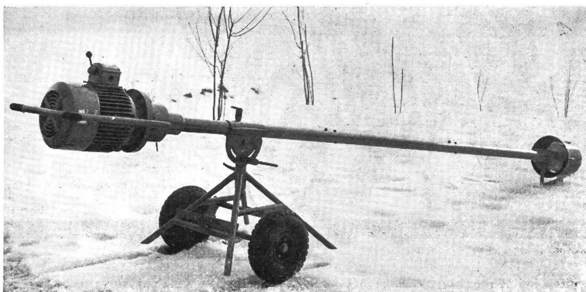
Abb. 20: Das transportable Güllentrührwerk «Jauchemixer» der Fa. A. Wälchli, Brittnau
