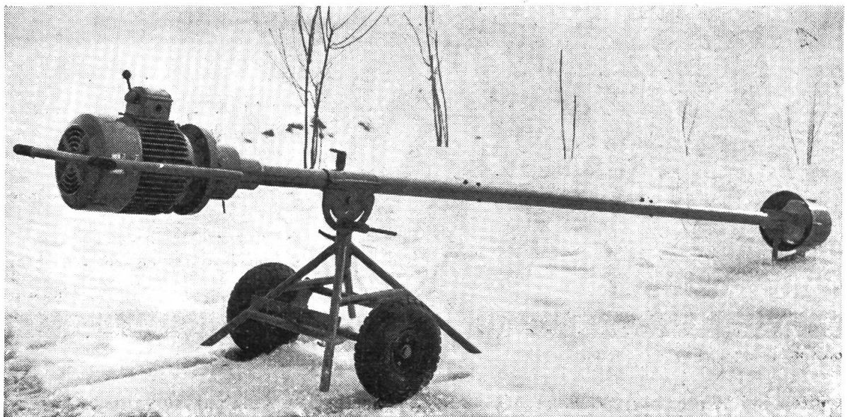
Abb. 20: Das transportable Güllenrührwerk «Jauchemixer» der Fa. A. Wälchli, Brittnau
