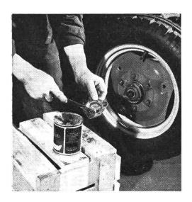
Ist die Achsmutter gesichert, nehmen wir die Radkappe zur Hand, reinigen sie gründlich, lassen sie abtrocknen und geben hochwertiges Schmierfett (Markenfett verwenden!) in die Radkappe (Abbildung 4). Das Aufsetzen und Anschrauben der Radkappe dürfte keine Schwierigkeiten bereiten.
