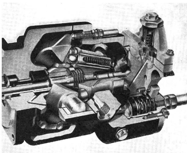
Bei der neuen hydrostatischen Kraftübertragung der Fa. Lucas wird die abgebildete hydraulische Pumpe, deren Wackel-Platte veränderliche Winkelstellungen einnehmen kann, vom Traktormotor angetrieben. Die Pumpe ist mit Rohrleitungen hydraulisch mit ähnlichen Pumpen verbunden, die die Hinterräder antreiben. Die veränderte Wackel-Platte ermöglicht stufenlose Geschwindigkeitsveränderungen nach vorwärts wie nach rückwärts.
