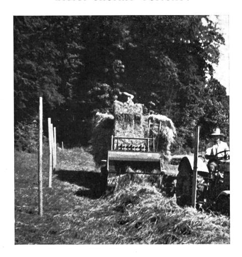
Rasche Arbeit, bis zu 8 Tonnen Stundenleistung Bequem durch Traktorfahrer zu bedienen
