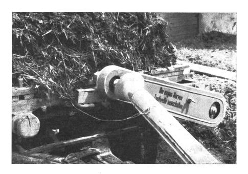
Abb. 3 Gelenkwellenschutz an Miststreumaschine. Näheres über Gelenkwellenschutz siehe Merkblatt M8
