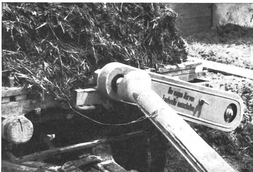
Abb. 3 Gelenkwellenschutz an Miststreumaschine. Näheres über Gelenkwellenschutz siehe Merkblatt M8
