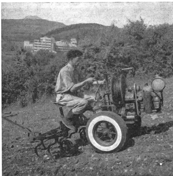
Abb. 4: Die «Spinne» bei zweireihigem Hacken im Steilhang (Einmann-Seilzug).
