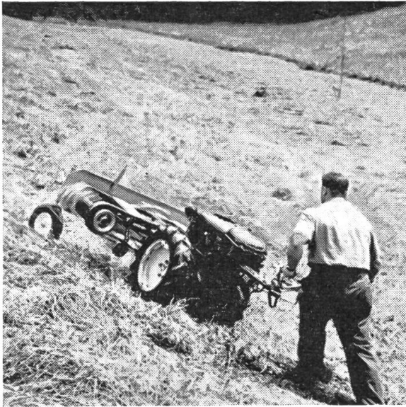
Abb. 3a und 3b: Front-Ketten- und Sternradrechen bei 40 bis 45 % Steigung. Mit den Sternradrechen muss bei diesem Gefälle in der Fallinie gefahren werden.
