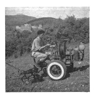
Abb. 4: Die «Spinne» bei zweireihigem Hacken im Steilhang (Einmann-Seilzug).
