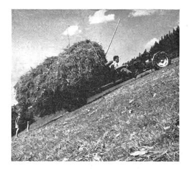
Abb. 1: Einachstraktor mit Triebachsanhänger am Steilhang.
