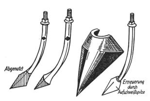
Unser Bild zeigt links die Abnützungserscheinungen an Löffeleggen-Zinken und rechts eine Aufschweißspitze und wie sie angesetzt werden soll.
