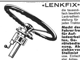
die tausendfach bewährte Lenkradfeststellung für jeden Traktor.
