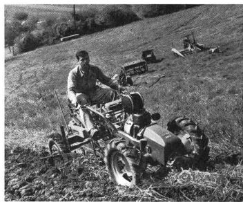
Die anfänglich als Zapfwellengerät zum Einachstraktor entworfene Seilzugmaschine wurde — obwohl durchführbar — hauptsächlich wegen der nicht befriedigenden Holmenlenkung aufgegeben.
