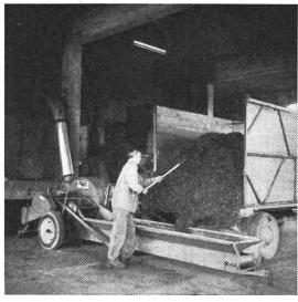
Abb. 9 und 10 Abladen mit dem Rollboden einer Mistzettmaschine sowie mit einer speziellen Abladevorrichtung. Das Häcksel fällt in den Fördertrog eines Gebläses. Die Bedienungsperson muss lediglich das regelmässige Abrutschen regeln.
