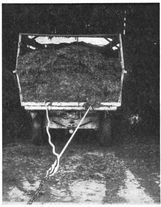
Abb. 6 und 7: Das Abladen der Wagen mit Seil. Der Traktor zieht mittels zwei auf der Wagenbrücke liegenden Seilen die ganze Ladung ab.
