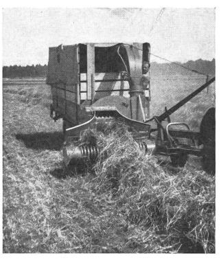
gezeigt, dass Traktoren zwischen 25 und 30 PS nur unter günstigen Bedingungen, d. h. zum Ernten von lagerfähigem Heu oder Mähdrescherstroh ausreichend sind. Unter normalen Verhältnissen, ohne starke Hanglage und für Grünfutter, sind Zugmaschinen mit 30 bis 35 PS erforderlich. Bei ungünstigen Arbeitsbedingungen benötigt man sogar einen Traktor von mindestens 40 PS.
