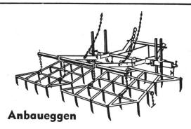
Sehr vorteilhaft, können auf Vielfachgerät HARUWY montiert werden 1,75 m bis 4,2 m, starr oder klappbar, mit oder ohne Spurlockerer VIELFACHGERÄT HARUWY sogleich ein solider Kultivator
