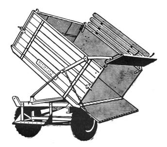
Die neue Lösung ist insofern besonders interessant, als sich die eine Seitenwand automatisch öffnet, wenn der Kasten gekippt wird. Dabei ist die grosse Kipphöhe besonders wertvoll. Zum Antrieb der Vollerntemaschine ist eine Gelenkwelle unter dem Rahmen des Fahrgestells angebracht. An der Ackerschiene hinter dem Bunkerkipper kann die Vollerntemaschine angehängt werden.
