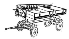
Nun gibt es viele Betriebe, die bereits einen gummibereiften Allzweckwagen besitzen, der mit verschiedenen Aufbauten versehen werden kann. Für diese Fälle ist die «Mechanicus» Düngerstreuer - Aufbaubrücke geschaffen worden, die auf ein vorhandenes Fahrgestell aufgesetzt werden kann.
