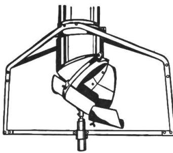
Unerreicht gleichmässige Verteilung von Grünfutter, Heu, Stroh, Körnern usw. Verblüffend einfach (rotiert ohne Antrieb), beliebig einstellbar, vielseitig und preiswert. Verlangen Sie bitte Offerte unter Angabe der Rohrweite. — Unentbehrlich für Belüftungsanlagen.
