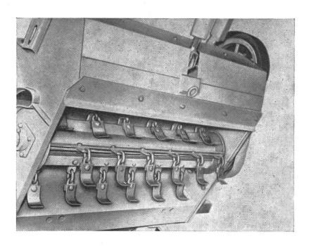
Abb. 4b: Schneidwerk des «Silotrac»
