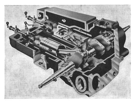
Abb. 2: Schnitt durch den liegenden 2-Zylinder-Motor des Vierzon 403
