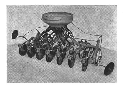
Abb. 3: Zentrifugal-Sämaschine Mc. Cormick
