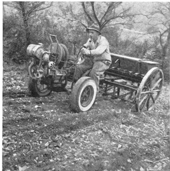
Abb. 12b: Die Gepanssämmaschine, angebaut an der Spinne
