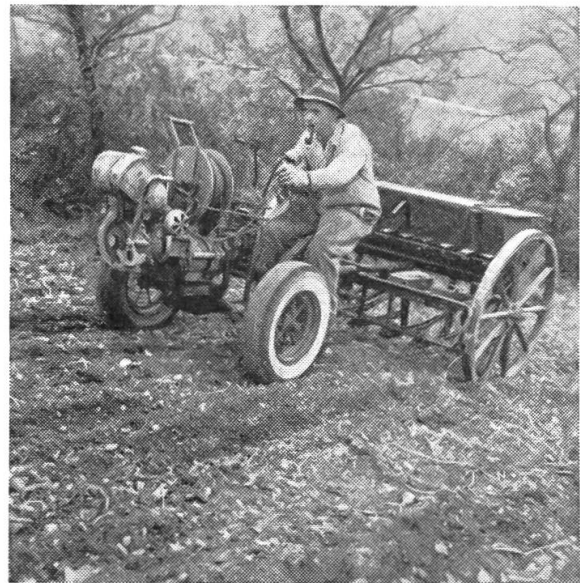
Abb. 12b: Die Gespannsämaschine, angebaut an der Spinne
