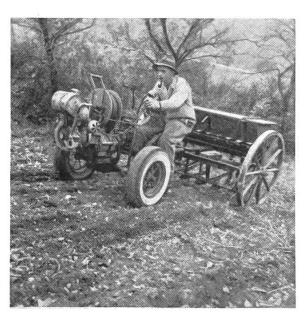
Abb. 12b: Die Gespannsämaschine, angebaut an der Spinne
