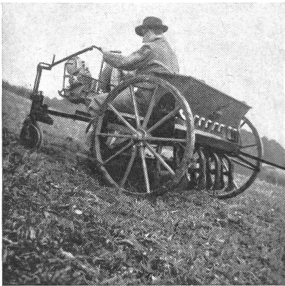
Abb. 12a: Erste Versuchsmaschine, bestehend aus Gespannsämaschine, Vorwagen (Grundgerät eines Traktor-Anbauvielfachgerätes) und Spillwinde
