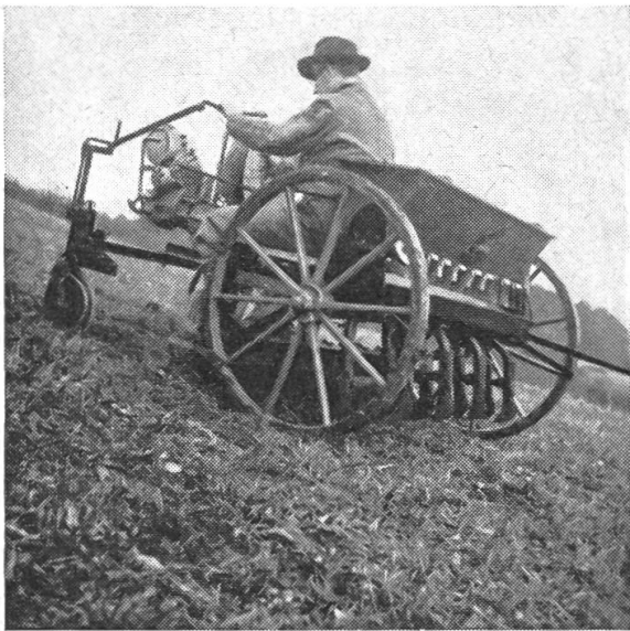
Abb. 12a: Erste Versuchsmaschine, bestehend aus Gepanssämmaschine, Vorwagen (Grundgerät eines Traktor-Anbauvielfachgerätes) und Spillwinde
