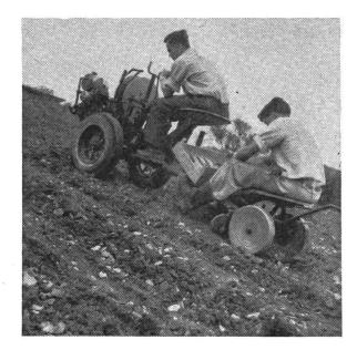
Abb. 9a Die Spinne, ausgerüstet mit halbautomatischem Pflanzapparat
