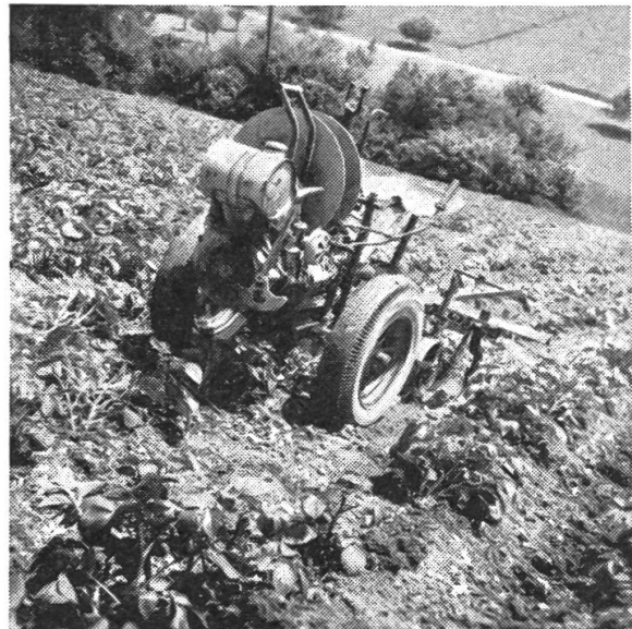
Abb. 10b: Hacken und Häufeln im gleichen Arbeitsgang
