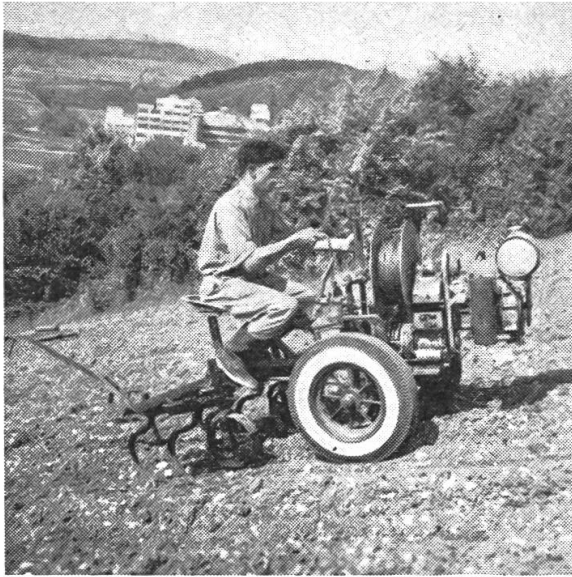
Abb. 10a: Hacken mit der Spinne und zwei-reihigem Hackgerät
