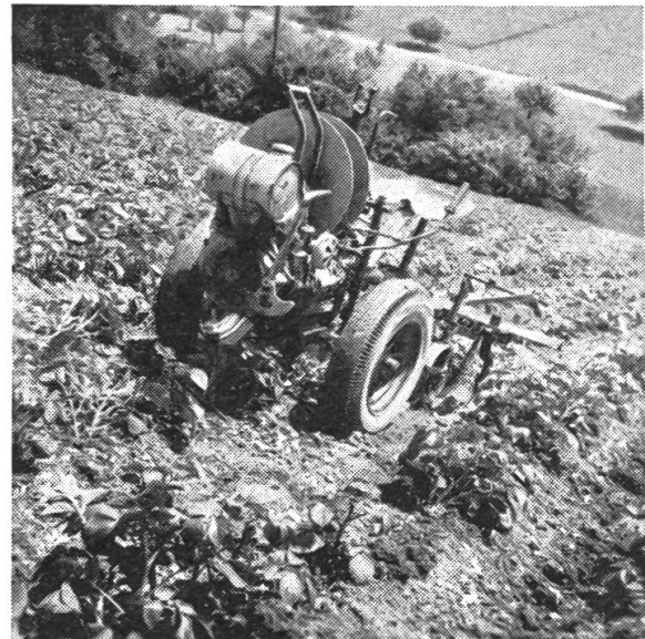
Abb. 10b: Hacken und Häufeln im gleichen Arbeitsgang
