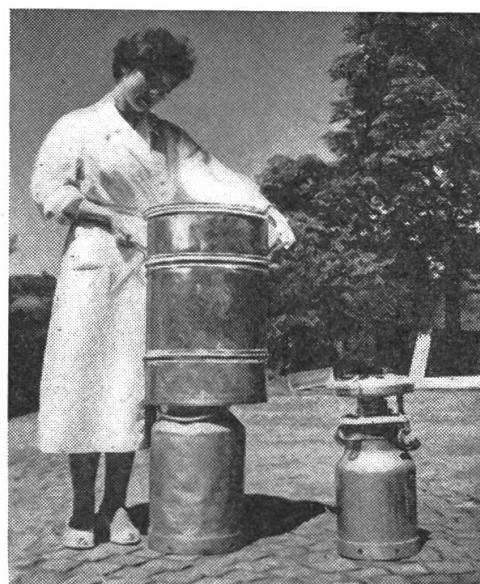
«Beli»-Kühlhalteglocke — Bei der Kühlhalteglocke ist der Raum zwischen Außen- und Innenmantel durch Glaswolle ausgefüllt. Sie wird über die Milchkanne gestülpt, nachdem die Milch gekühlt ist. Selbst bei grosser Außenwärme steigt die Temperatur der Milch unter der Kühlhalteglocke nur 1°.
