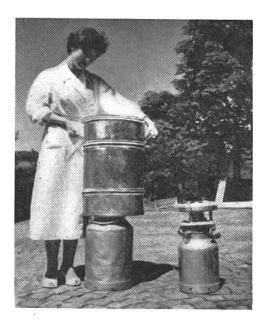
«Beli»-Kühlhalteglocke — Bei der Kühlhalteglocke ist der Raum zwischen Aussen- und Innenmantel durch Glaswolle ausgefüllt. Sie wird über die Milchkanne gestülpt, nachdem die Milch gekühlt ist. Selbst bei grosser Aussenwärme steigt die Temperatur der Milch unter der Kühlhalteglocke nur 10.
