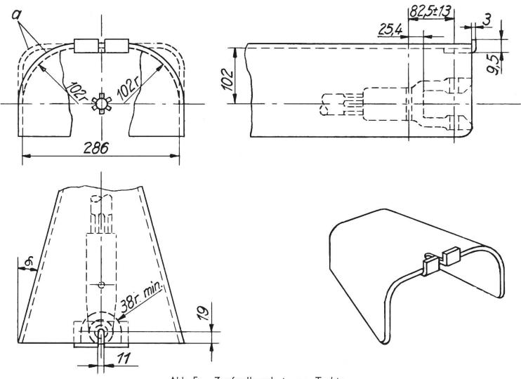
Abb. 5: Zapfwellenschutz am Traktor.  $\alpha = \text{Winkel beliebig.}$   $\alpha = \text{Formgebung beliebig.}$
