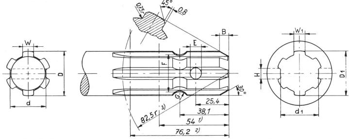
Abb. 1: Abmessungen der von der ISO vorgeschlagenen Zapfwelle.
