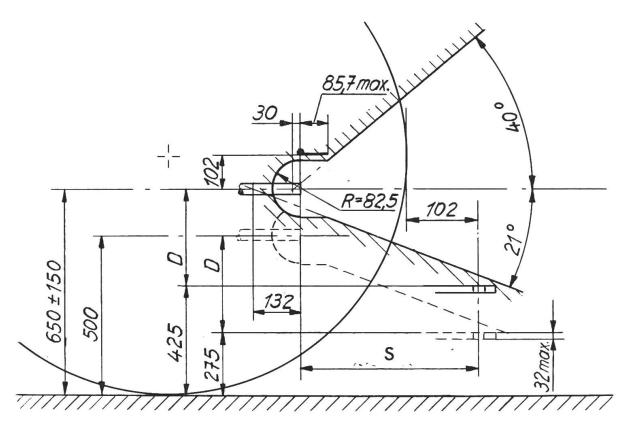
Abb. 4: Freiraum um die Zapfwelle u. deren Lage zur Anhängeschiene (Ansicht von der Seite)  $S = 355 \pm 10 \text{ mm} \text{ bei Traktoren ohne Dreipunkt-Aufhängung.}$   $550 \pm 10 \text{ mm} \text{ bei Traktoren mit Dreipunkt-Aufhängung.}$   $D_{\text{min.}} = 203 \text{ mm.}$
