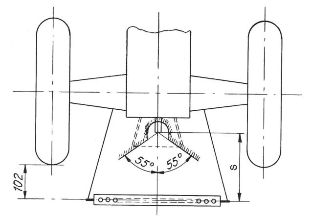
Abb. 3: Freiraum um die Zapfwelle und deren Lage zur Anhängeschiene (Ansicht von oben).  $S=355\pm10~\text{mm}~\text{bei}~\text{Traktoren}~\text{o}~\text{h}~\text{n}~\text{e}~\text{Dreipunkt-Aufhängung}.$   $550\pm10~\text{mm}~\text{bei}~\text{Traktoren}~\text{m}~\text{i}~\text{t}~\text{Dreipunkt-Aufhängung}.$
