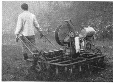
Abb. 8: Die Egge mit aufgebauter Selbstaufzugwinde
