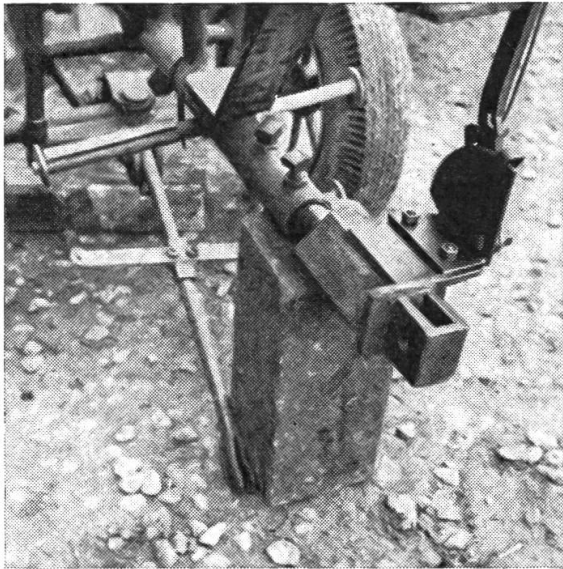
Abb. 5a: Behelfsmässige Anbauvorrichtung an der Heckseite des Geräteträgers
