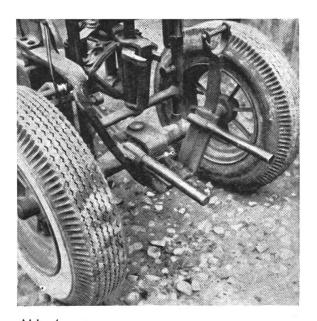
Abb. 4: Tragzapfen für den frontalen Anbau der Selbstaufzugwinde
