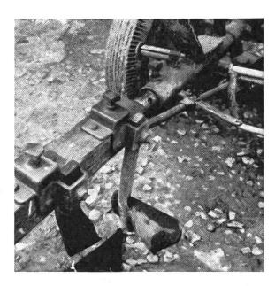
Abb. 6: Einfacher Geräteanbau. Der Pflugkörper wird mittels Zapfen am Grendelstummel eingesteckt
