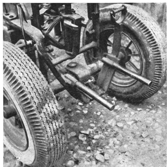
Abb. 4: Tragzapfen für den frontalen Anbau der Selbstaufzugwinde
