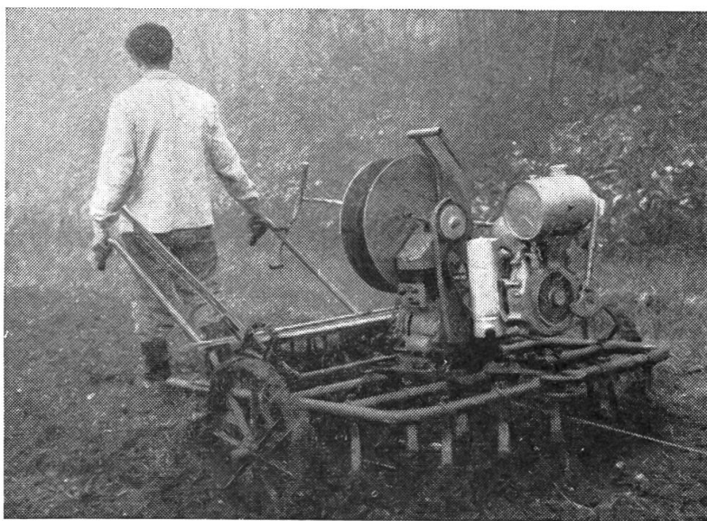
Abb. 8: Die Egge mit aufgebauter Selbstaufzugwinde
