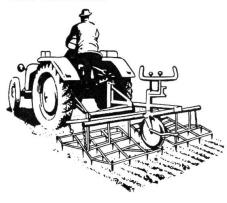
Doppelwirkende Anbauegge, durch Steuerträger belastet und unbelastet arbeitend. Nutzbare Arbeitsbreite 2,20 m.
