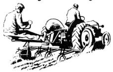
Hochwertige, hangsichere Hackmaschine durch Feinsteuerung der einzelgefederten Hackwerkzeuge in der Ebene und am Hang. Eignet sich ausgezeichnet für alle Hackkulturen. Arbeitet mit oder ohne Steuermann.
